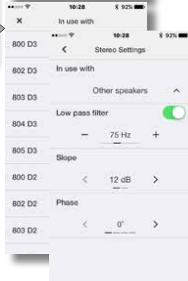
Stereo nastavení: volba dolnoproústného filtru či jeho konfigurace.
