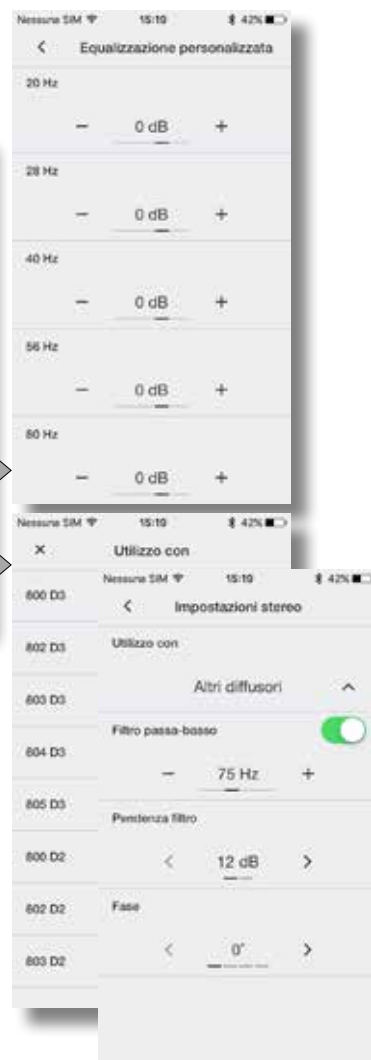
Impostazioni stereo: selezione filtro passa basso o regolazione manuale parametri
